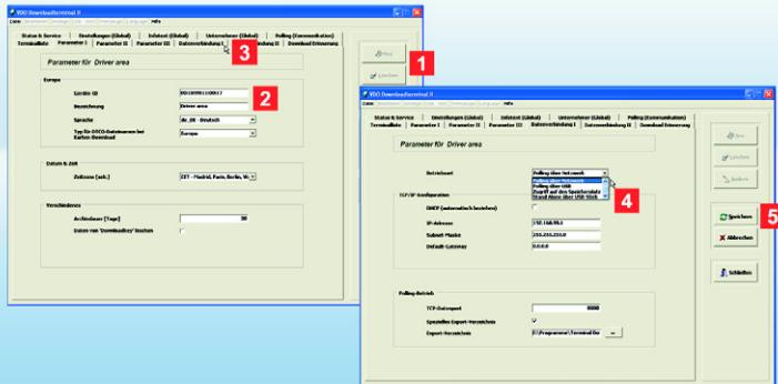
**Information:** I konfigurationsmjukvaran angivs de förinstallerade standardvärdena för nätverksadressen, nätverksmasken och gateway. Fråga din nätverksadministratör, om du kan använda dessa värden:
