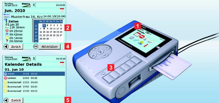
**Recomandare:** Terminalul de descărcare II este dotat cu taste funcționale care răspund chiar și la o atingere ușoară. Dacă atingeți de exemplu o tastă-sâgeată, vă puteți deplasa în meniu cu un punct de meniu la dreapta, stânga, în sus sau în jos. Confirmăți meniul selectat cu **OK**.
