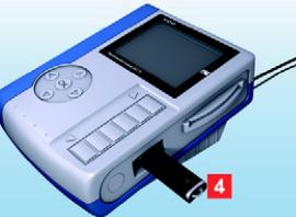
**Указание:** USB-накопитель для загрузки должен принципиально конфигурироваться через пункт меню **USB-накопитель**, т.к. файлы на вашем считывающем терминале защищены от несанкционированного доступа.
