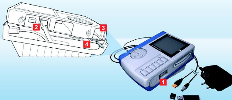
**Pozor:** pred otvorením sťahovacieho terminálu II vytiahnite adaptér zo zásuvky.
