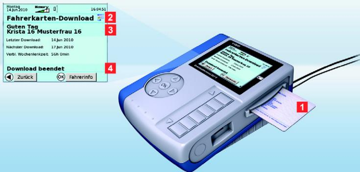
**Указание:** Каждый раз, когда вставляется карта водителя или считывающий ключ, загружаются данные, которых еще нет в запоминающем устройстве считывающего терминала II.
