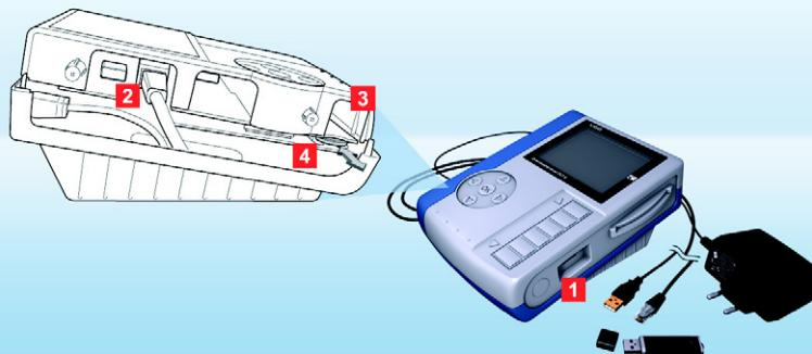
**Opreznost:** Izvucite adapter iz utičnice pre nego što otvorite terminal za preuzimanje II.
