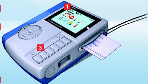
**Namig:** Downloadterminal II ima funkcionske tipke, ki so odzivne že na rahel dotik. Če se npr. dotaknete smerne tipke, se boste v meniju pomaknili desno, levo, navzgor ali navzdol za eno točko menjica.
