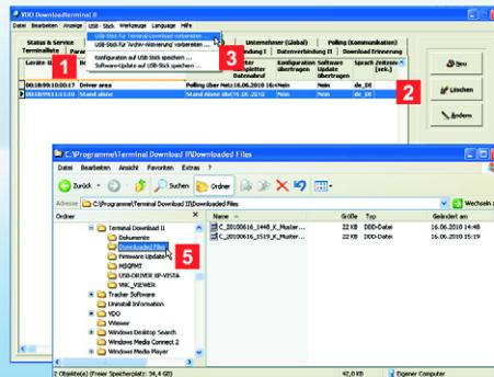
**Indicație:** Sticul USB destinat descărcării datelor trebuie configurat de regulă prin punctul de meniu **Stic USB**, deoarece fișierele din terminalul dumneavoastră de descărcare II sunt protejate împotriva accesului neautorizat.
